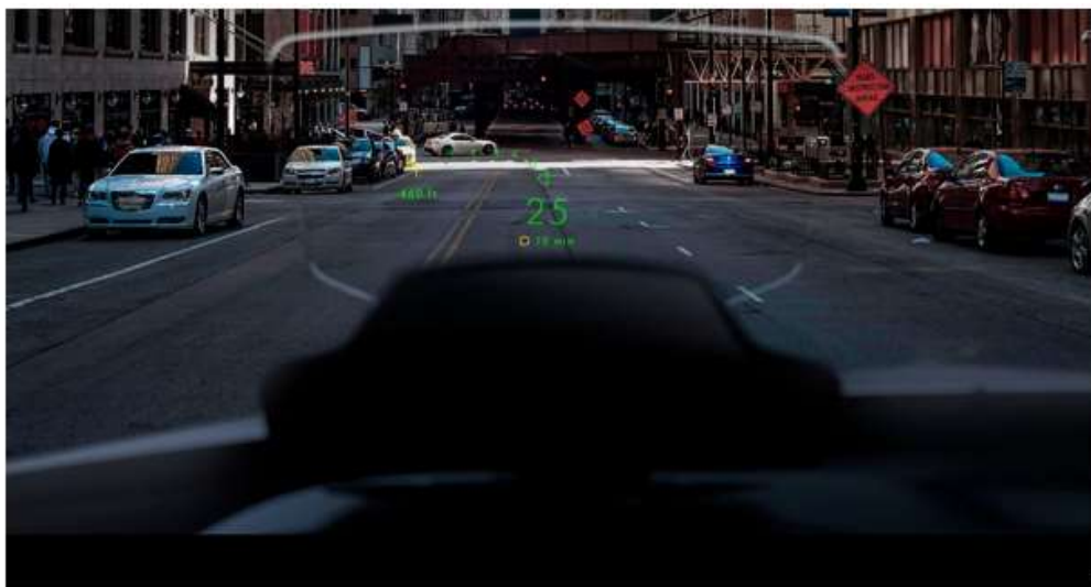
Fig. 3 : Dans le concept WAYRAY, les données changent au fur et à mesure que la voiture avance et que l'on sollicite une partie ou une autre du champ de vision.
